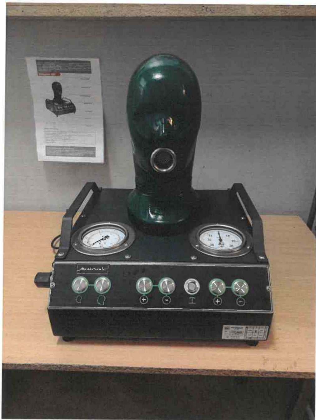
Zdjęcie 5. Moduł urządzenia testowego do manualnego przeprowadzania badań statycznych masek nadciśnieniowych - Masktronic Compact 200.
