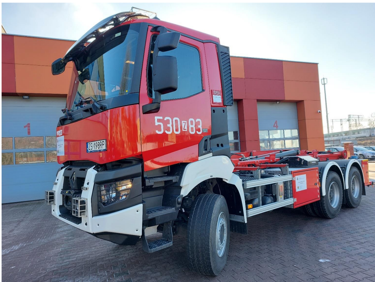
Ciężki samochód nośnik kontenerowy z hakowym urządzeniem ładunkowym na podwoziu Renault K z napędem 6x6 wraz z wyposażeniem Wartość zakupu 1 099 989,00
