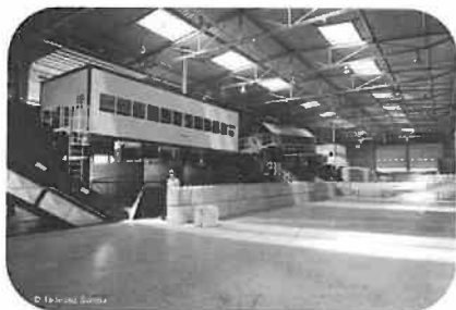
Linia technologiczna do sortowania zmieszanych odpadów komunalnych.
