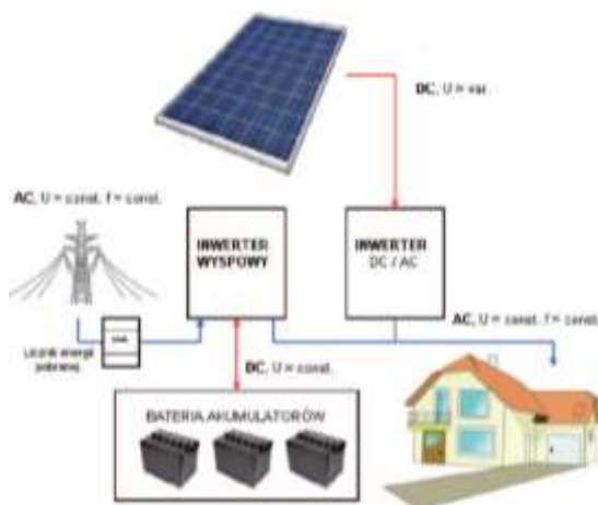
Rysunek 27 Schemat instalacji mieszanej 173 (oznaczenia: DC- prąd stały, AC-prąd przemienny, U- napięcie, f-częstotliwość, var.-zmiennie, const.- stałe)
