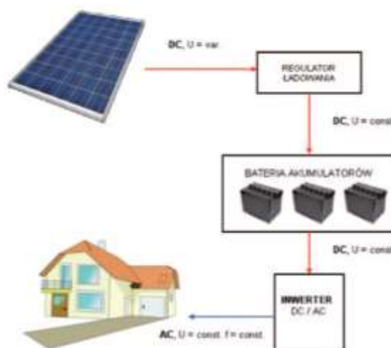
Rysunek 26 Schemat instalacji OFF-GRID 172 (oznaczenia: DC- prąd stały, AC-prąd przemienny, U- napięcie, f-częstotliwość, var.-zmiennie, const.- stałe)
